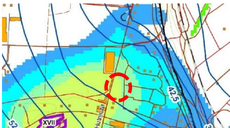
Przestrenny rozkład koncentracji fenoli (mg/l) symulacja transportu masy MT3D DMS
